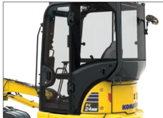
Cabina de nuevo diseño, estilo MR-5, con entrada más amplia, mayor espacio para el operador y muchas características de seguridad mejoradas.
