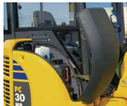
Capó delantero: acceso fácil al depósito de combustible
