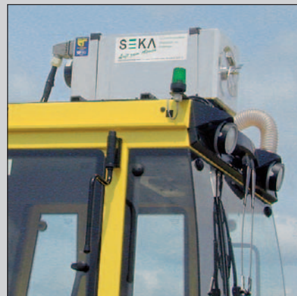
Sistema de protección de ventilación en la cabina.
