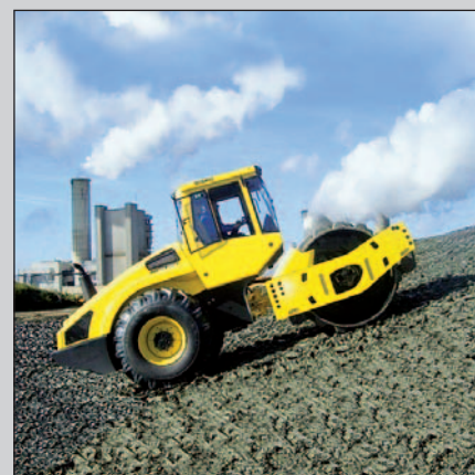
BW 213 DH-4 con segmentos pata de cabra compactando un recubrimiento de un vertedero.
