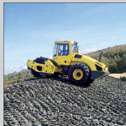
Rodillos autopropulsados con rodillo pata de cabra son de primera para la compactación de suelos cohesivos, aquí el BW 214 PDH-4.
