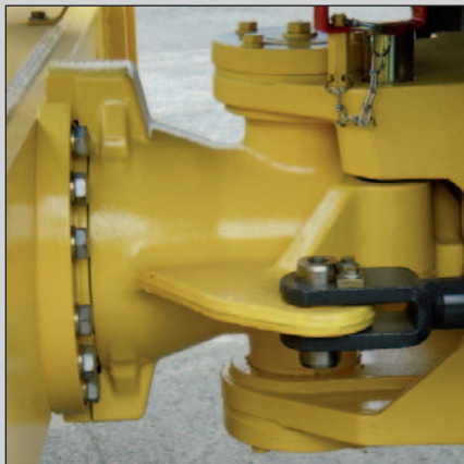
La articulación pivotante libre de mantenimiento (hasta BW 216).
