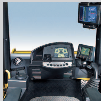
Vista del panel de instrumentos en rodillos autopropulsados BVC con mini-volante y pantalla LCD.
