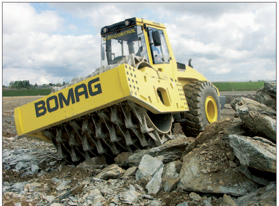
El BW 226 RC-4 BVC con rodillo triturador de rocas no detiene la compactación de rocas.
