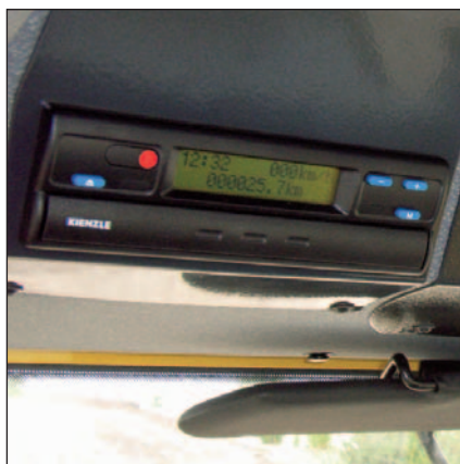
El tacógrafo registra tiempo de trabajo, frecuencia de vibración y velocidad de marcha.
