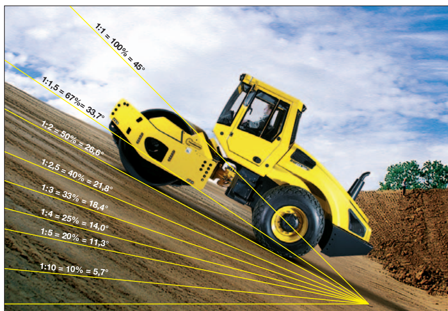
BW 213 PDH-4 en la compactación de una capa de cierre de arcilla para un vertedero.
