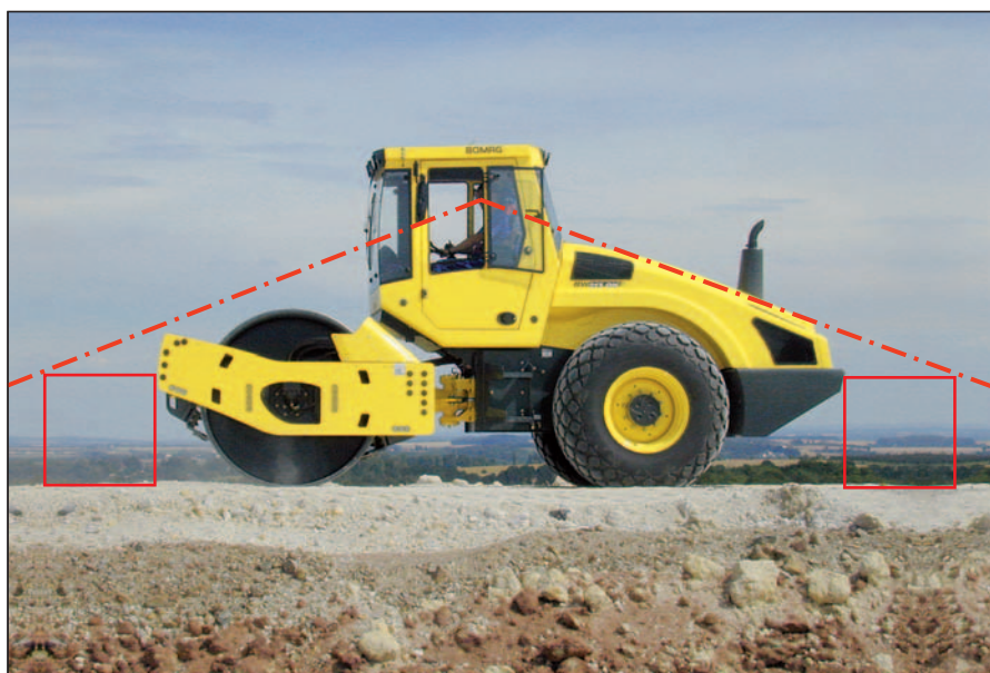
Todos los rodillos autopropulsados cumplen la norma 1-m-x-1-m. De esta forma queda asegurada la mejor visión panorámica y máxima seguridad en la obra.
