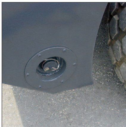
Equipo de alimentación de combustible a presión para repostar de forma rápida.
