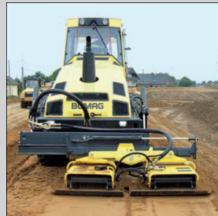
BW 213 DH-4 BVC con bandejas acopladas para la compactación de la superficie.
