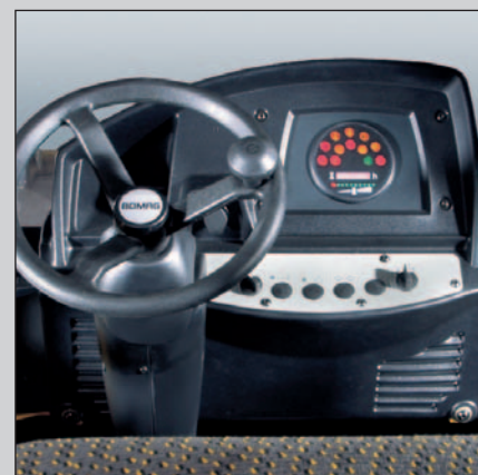
Vista del panel de instrumentos de rodillos autopropulsados D-4/DHC-4/PD-4 y PDHC-4 con volante descentralizado e instrumento redondo.
