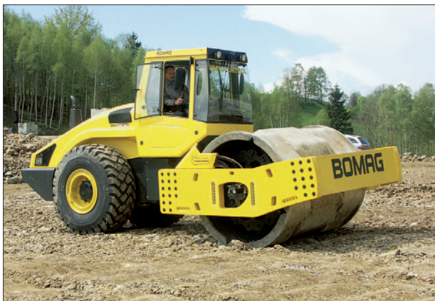
Rodillos autopropulsados con rodillo poligonal, en la imagen el BW 226 DI-4 BVC, permiten un aumento del espesor de capa hasta el 100%.
