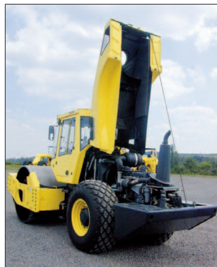
Todos los componentes en el compartimiento del motor son de fácil acceso después de abrir la cubierta.
