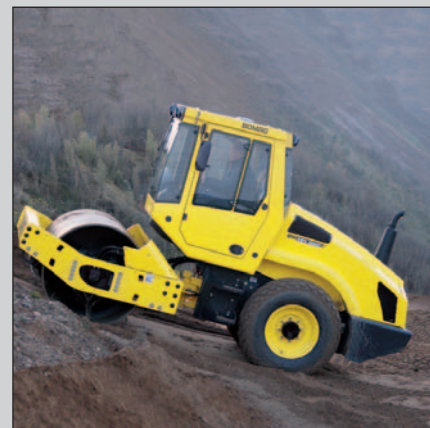
BW 177 DHC-4 durante la compactación de una mezcla de grava y arena.
