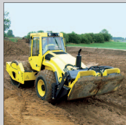
A pesar de las condiciones más difíciles, los rodillos autopropulsados se abren camino, como en la imagen un BW 213 DI-4 BVC con bandejas acopladas.
