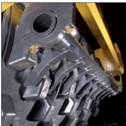
Kit de segmentos pata de cabra para compactar material cohesivo, para rodillos autopropulsados con rodillo liso.
